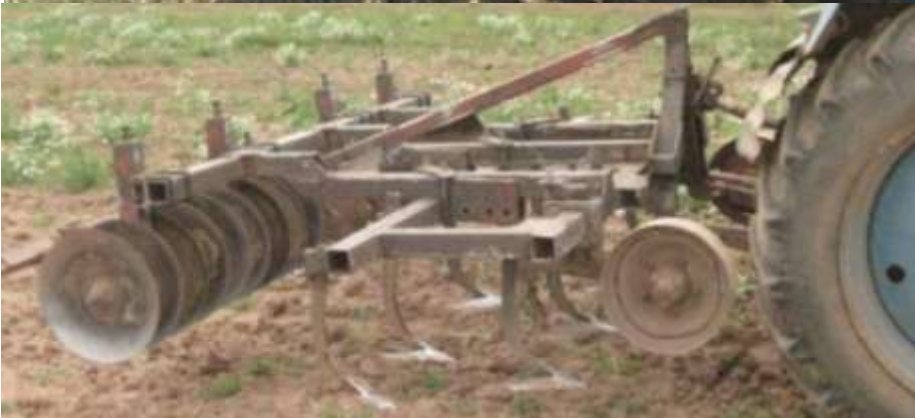
Рисунок 10 – Общий вид многофункционального агрегата МПА-2,2/3,0 со сменными рабочими органами для основной (а) и мелкой (б) обработки почвы
