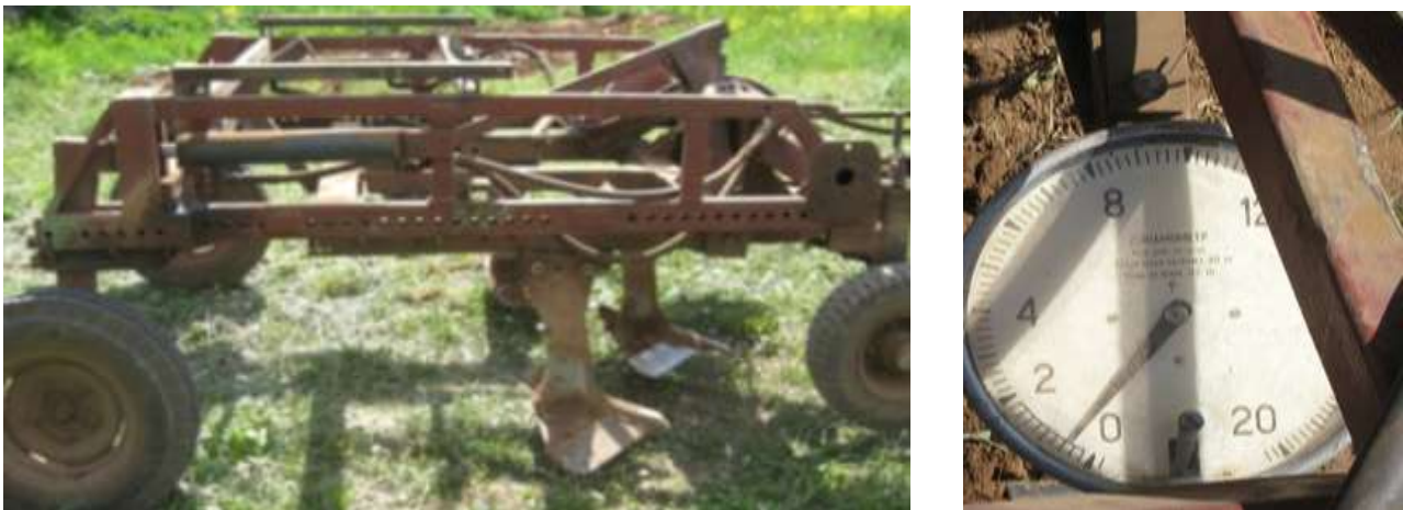
Рисунок 6 – Лабораторно-полевая установка: а – общий вид; б – расположение динамометра на снице установки
